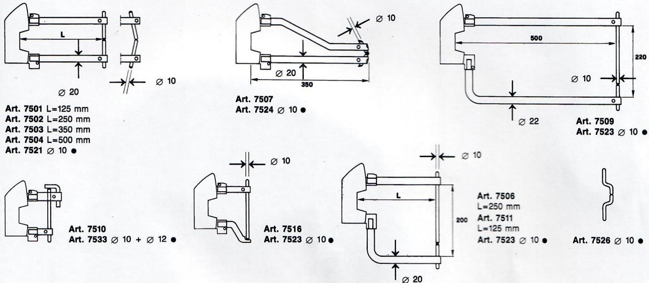
Bracci raffreddati ad acqua / Water-cooled arms / Bras refroidis par eau / Wassergekühlte Arme / Brazos refrigerados por agua
