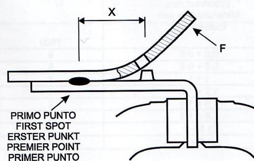
TEST DI TRAZIONE - PULLING TEST
